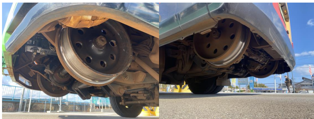
写真IV－2 車体の下に格納された鉄車輪
