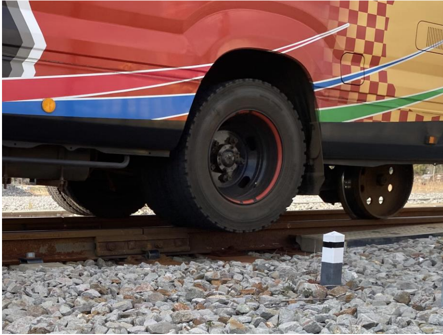
写真IV-3 線路上に載る後輪のゴムタイヤ
